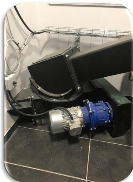
Fjäderförrådet ligger plant i botten och växlas över till den lutande skruven.
